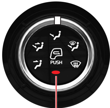
외기 차단 상태 표시등
