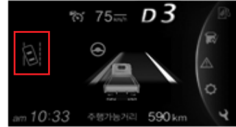
4.3인치 컬러 LCD 디스플레이 장치
