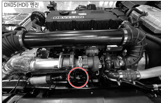
1) DX05(HDI) 엔진 캡을 올리면 엔진 오른쪽(조수석 쪽) 하단부에 게이지가 있습니다.
