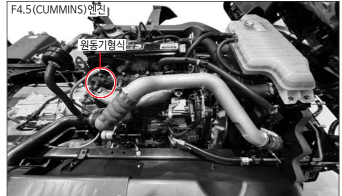
F4.5 (CUMMINS) 엔진은 실린더블록 우측 상단 뒤쪽에 새겨져 있습니다.
